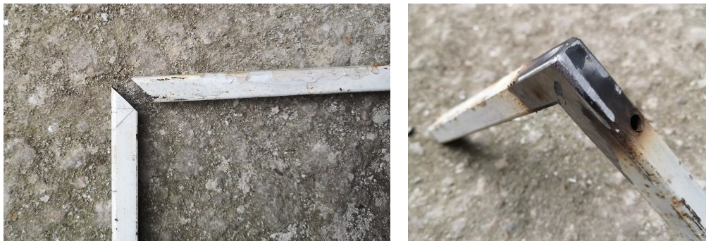
Obr. 101 Ohnutí profilu ze dvou kusů
