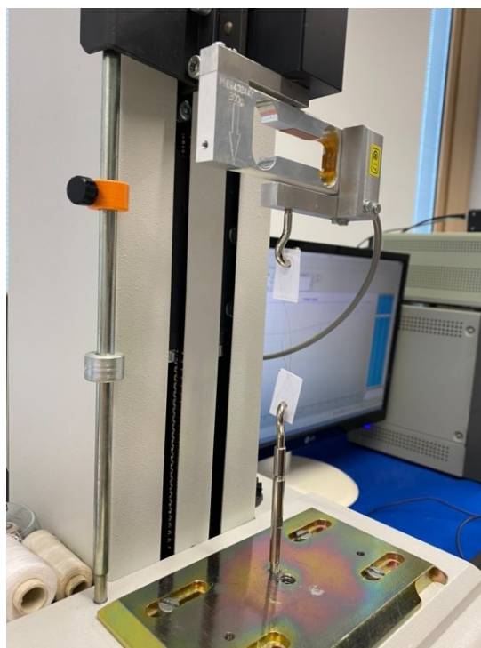
Obrázek č. 7: Upnutí vzorku v držáku
