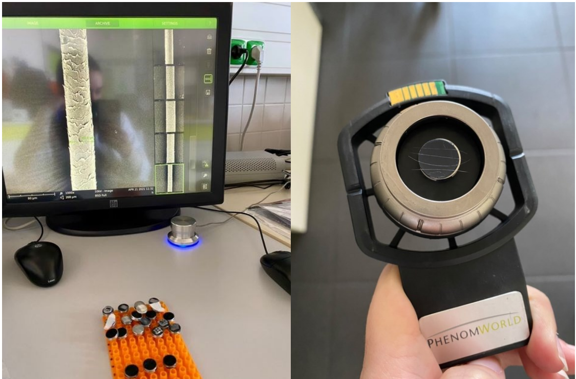
Obrázek č. 9: Software přístroje (vlevo) a držák s terčičkem a nalepenými vzorky (vpravo)
