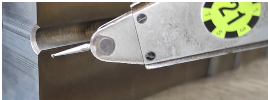
Obr. 64 Poloha úchylkoměru na začátku díry
