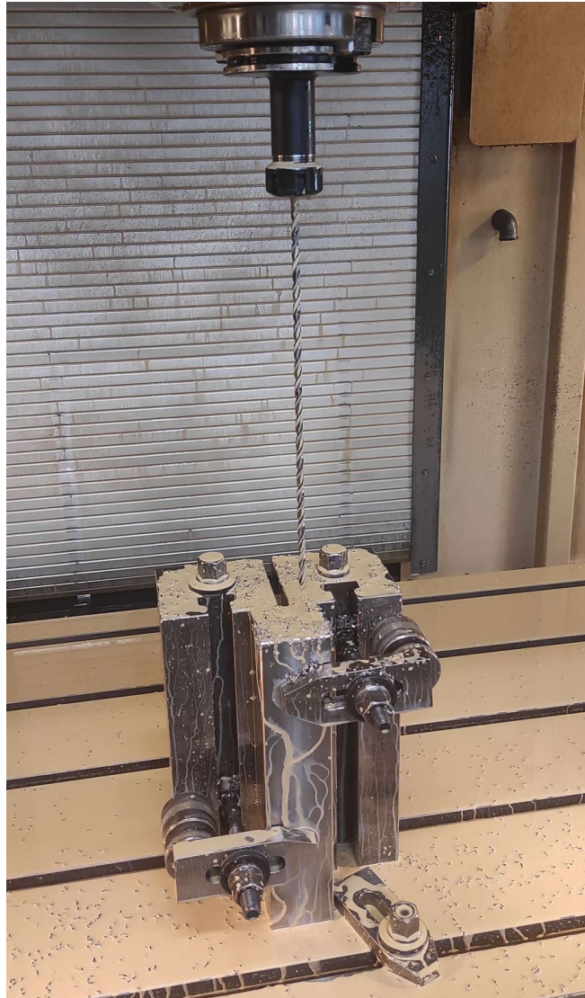
Obr. 50 Upnutí testovací kostky během vrtání
