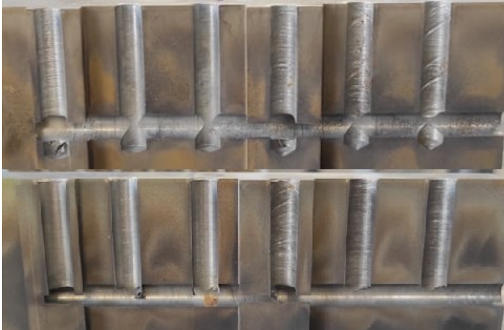
Obr. 67 Rozdíl při změně postupu vrtání u materiálu ČSN 11 523
