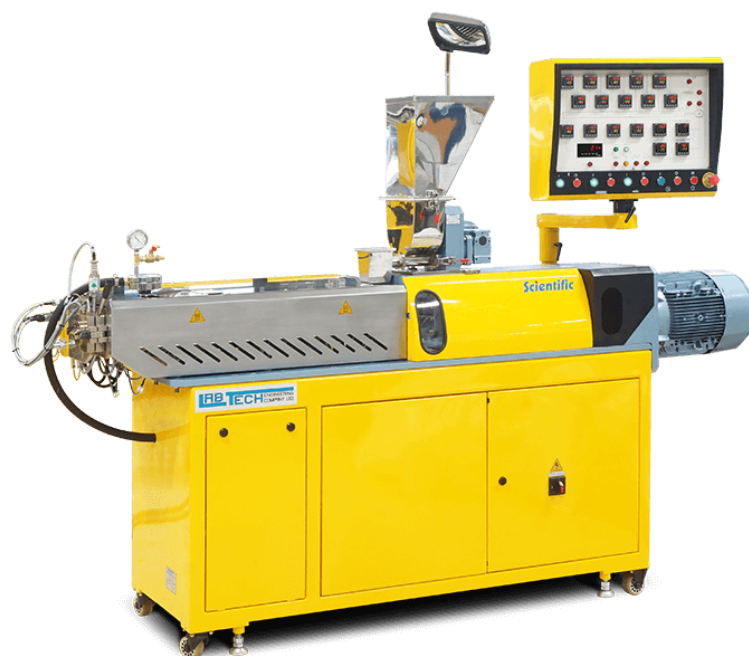
Obrázek 13 Kombinovaný dvoušnekový extrudér (26 mm) [61]
