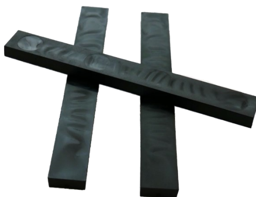
Obrázek 14 Příklad vstřikovaných zkušebních tělísek
