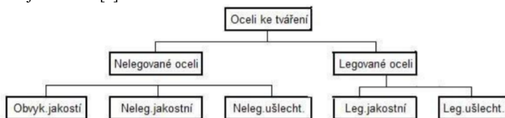
Obr. 2 Schéma rozdělení ocelí ke tváření [1]
