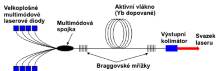
Obrázek 16. Vznik vláknového laseru [18].
