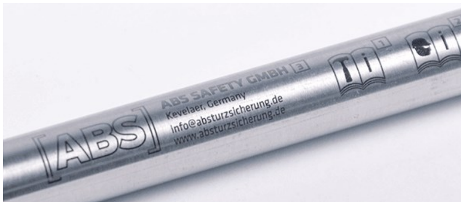
Obr. 29 Označený materiál metodou žiháním [6]
