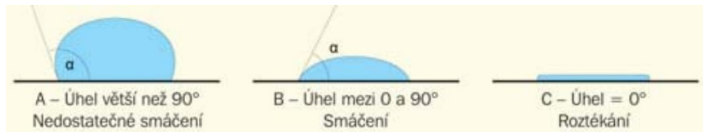
Obr. 50 Různé druhy kontaktního úhlu při posuzování smáčivosti[35]
