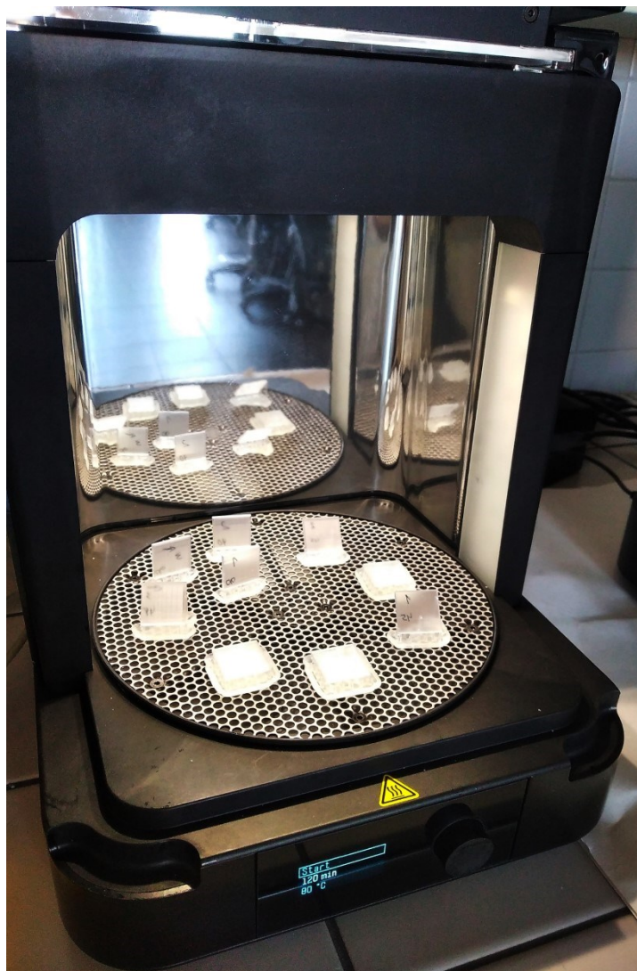
Obr. 48 Příklad přístroje na dodatečné vytvrzení pryskyřice Form Cure
