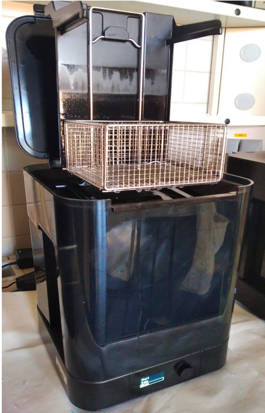
Obr. 47 Příklad přístroje na oplachování nevytvrzené pryskyřice Form Wash
