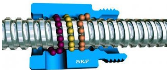
Obr. 14 - Řez kuličkovým šroubem s ukázkou oběhu kuliček [15]
