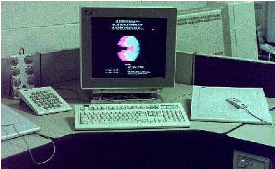
Obrázek 7: CAD pracovní stanice IBM 6090 a displej s rastrovou grafikou [3]
