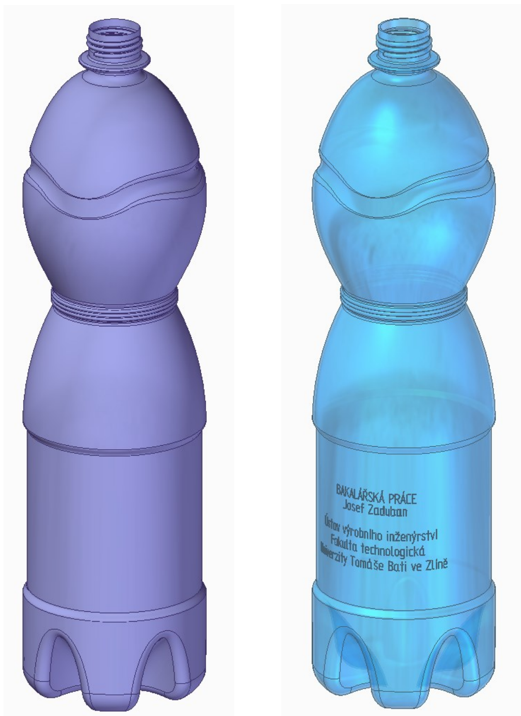
Obrázek 43: Finální model – PET láhev plošně vymodelovaná a převedená na objem
