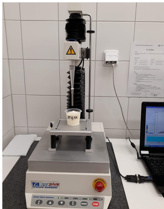
Obrázek 19 – Měření na analyzátoru textury
