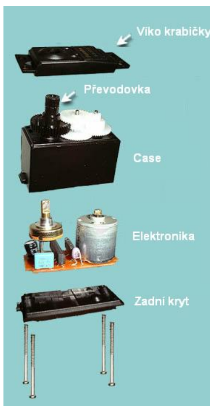
Obrázek 13. Vnitřní stavba serva
