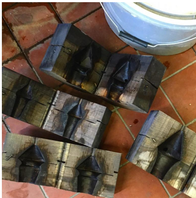
Obrázek 22 Dřevěné formy na zátky
