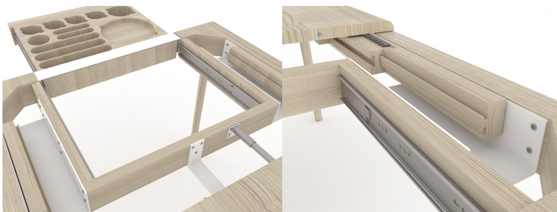
Obr. 122 Vizualizace: Uchycení rámu s detailem na výsuv
