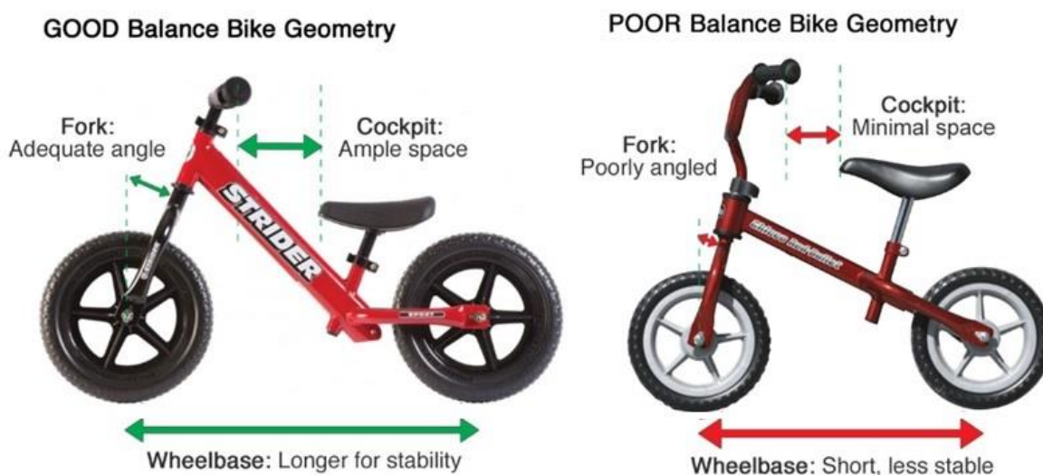
Obrázok 18 - Porovnanie dobrej a zlej geometrie bicykla
