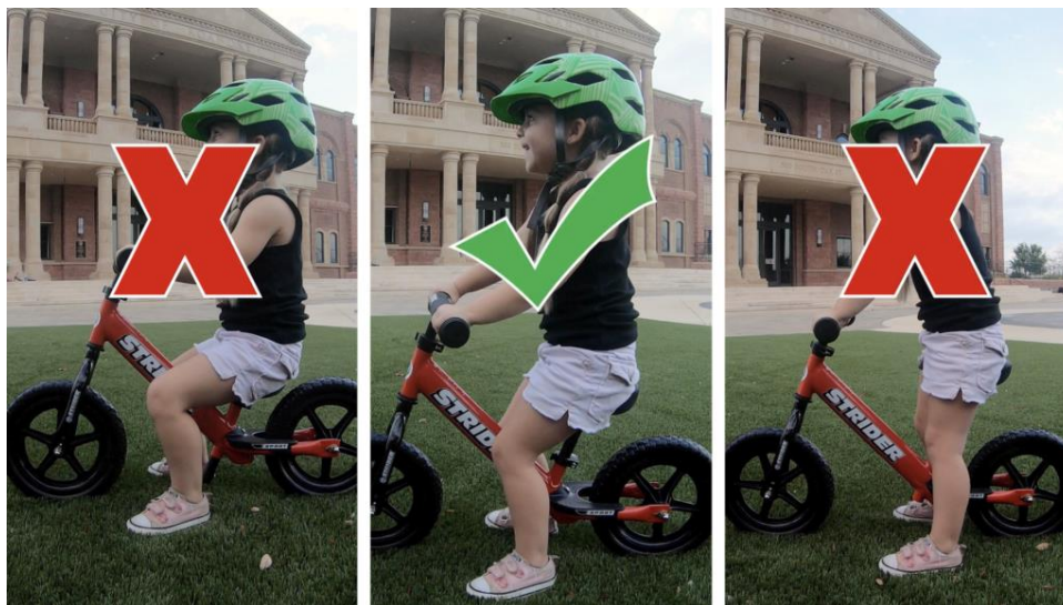
Obrázok 22 - Nastavenie správnej výšky sedla
