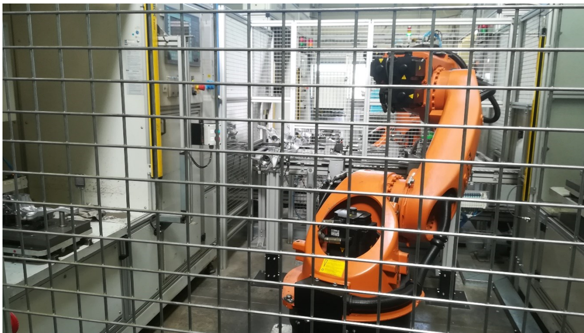
Obrázek 14 – Stanice tlakové zkoušky obsluhováno robotem (vlastní zpracování)
