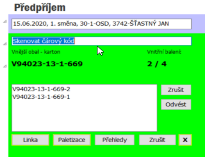
Obrázek 16 Předpříjem - skenování vnitřních obalů - Výstup z ERP systému
