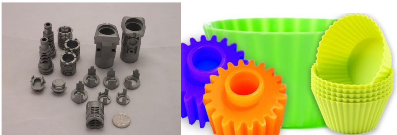
Obr. 22. Příklady vakuového lití kovu a polyuretanu.
