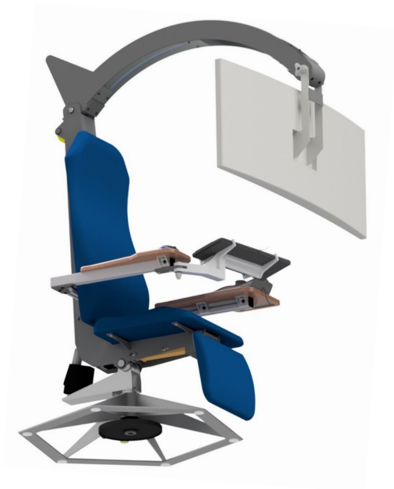
Obr. 70. Konečný vzhled pracovní stanice bez náklonu, v provozu.
