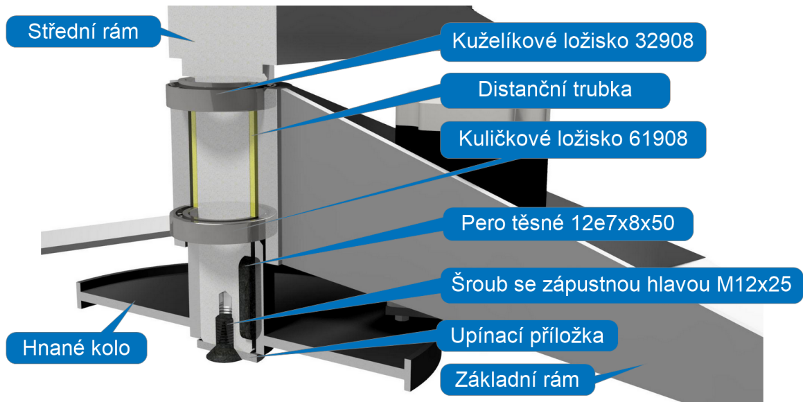
Obr. 50. Uložení pohyblivé části kolem osy D.
