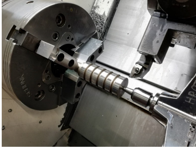
Obr. 29 Obrábění vzorku číslo 1 břitovou destičkou z CBN
