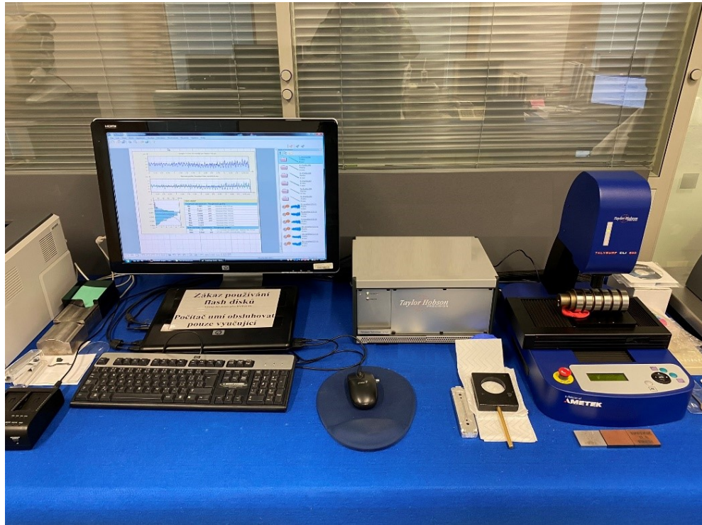
Obr. 33 Soustava pro bezkontaktní měření drsnosti
