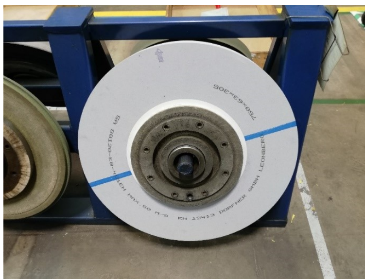
Obr. 31 Použitý brusný kotouč o rozměrech 750 x 63 x 305 mm
