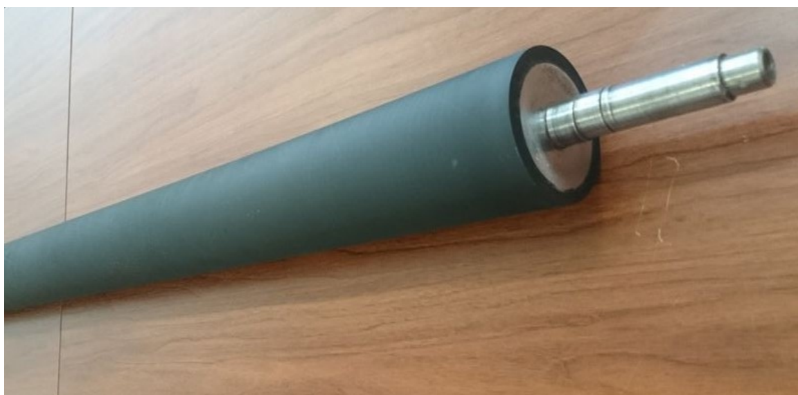
Obrázek 7: Hotový výrobek upravený broušením
