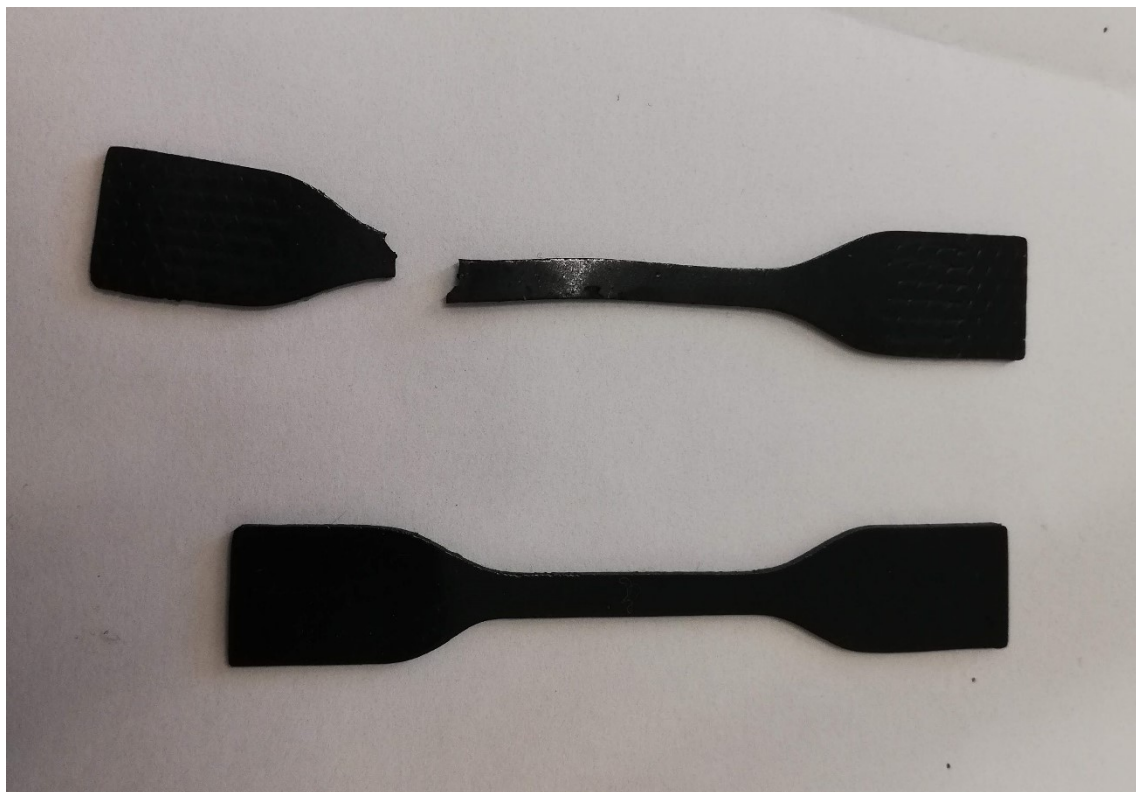
Obrázek 16: Zkušební vzorky před a po tahové zkoušce
