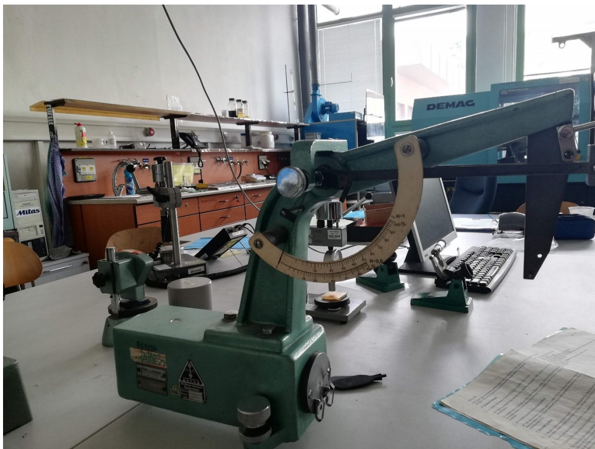
Obrázek 14: Přístroj ke stanovení odrazové pružnosti – kyvadlo Schob
