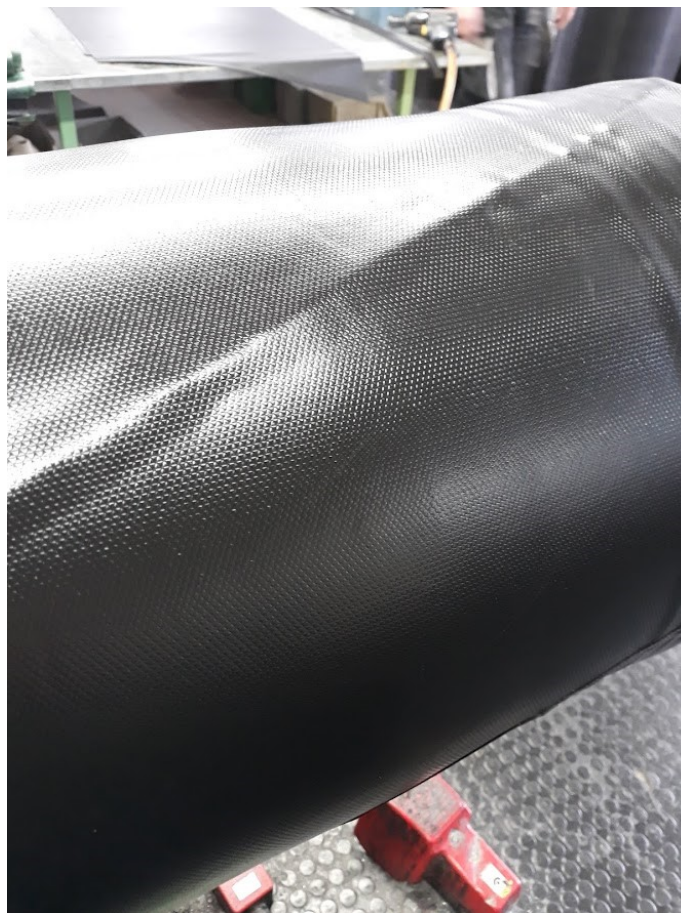
Obrázek 8: Směs ve fólii nanášená na formě při výrobě membrány
