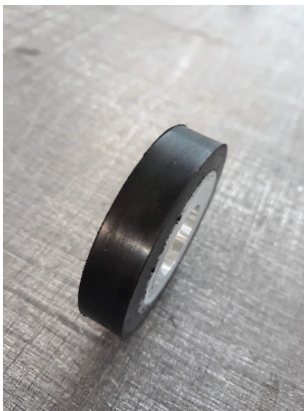
Obrázek 4: Lisovaná kladka ze směsi FO s duralovým jádrem
