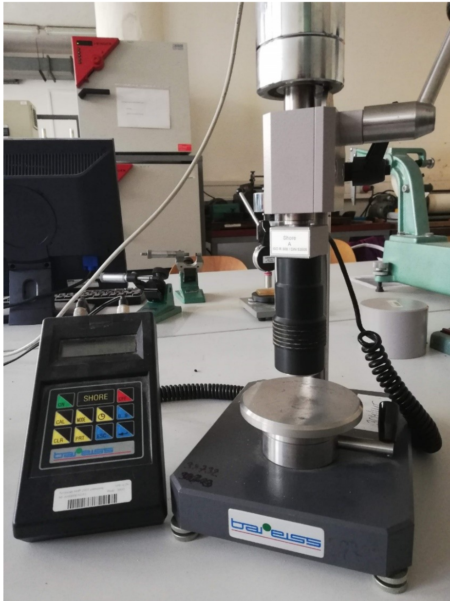
Obrázek 13: Přístroj ke stanovení tvrdosti Shore
