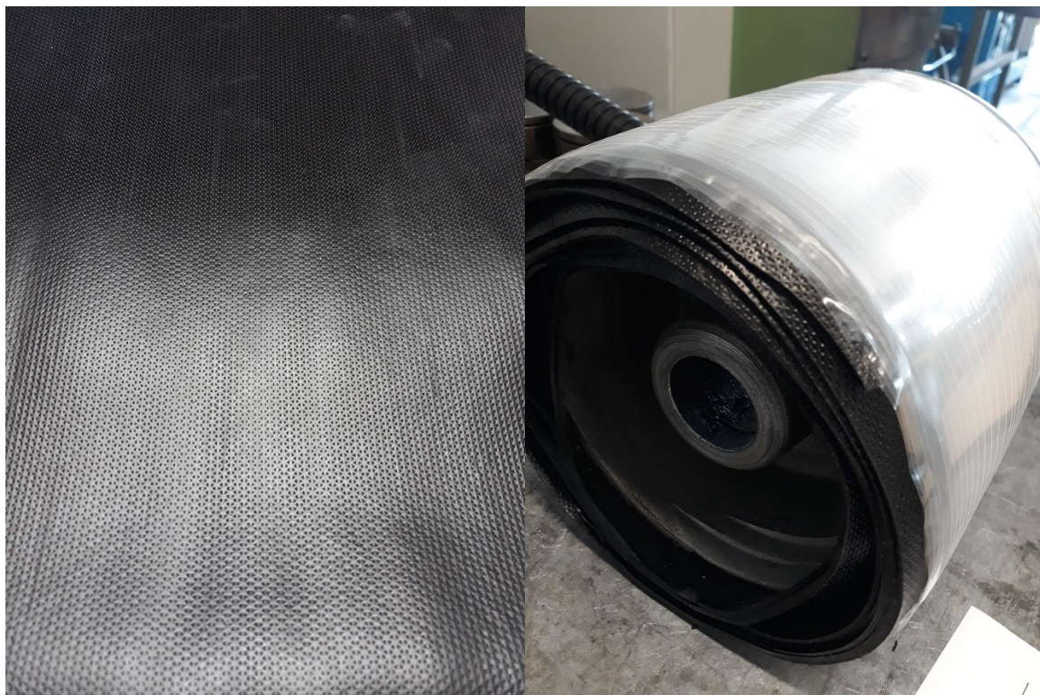
Obrázek 5: Směs FO ve fólii a její použití bandážováním pro pogumování válců
