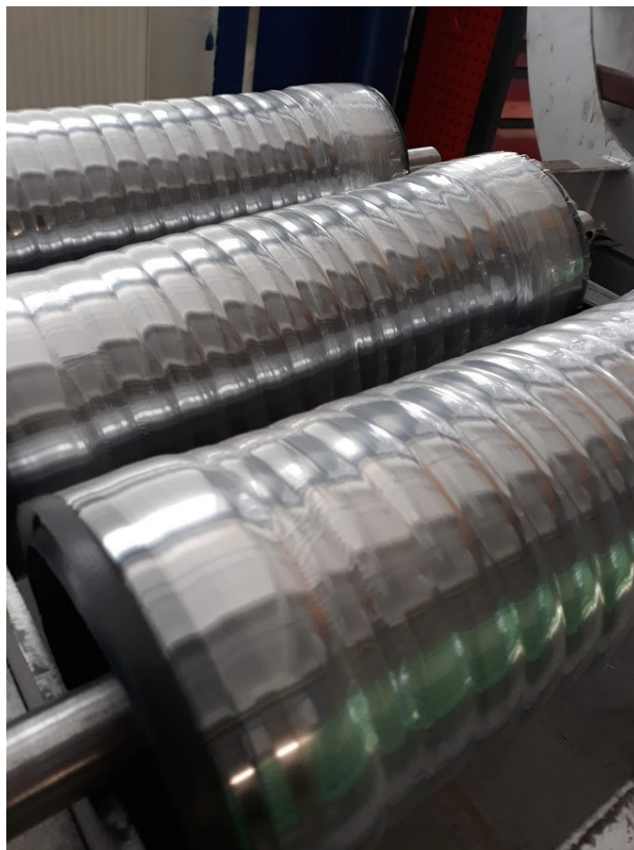
Obrázek 6: Válec za použití technologie bandážování v profilu
