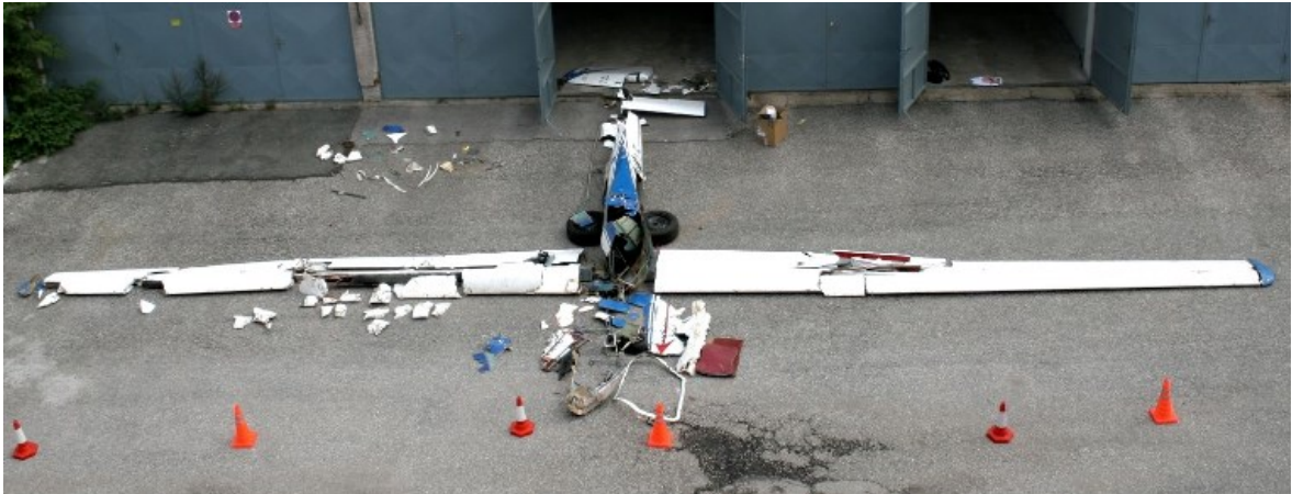
Obrázek 3: Rekonstrukce kluzáku ze zajištěných trosek. [45]
