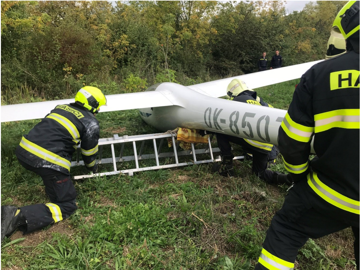
Obrázek 12: Provádění zajištění polohy letadla. Zdroj: [vlastní]
