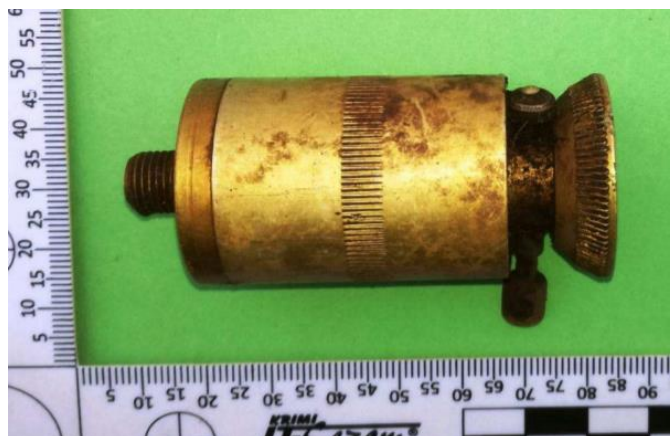
Obrázek 7 Nalezený minový rozněcovač DZ-35 [zdroj: Chládek]
