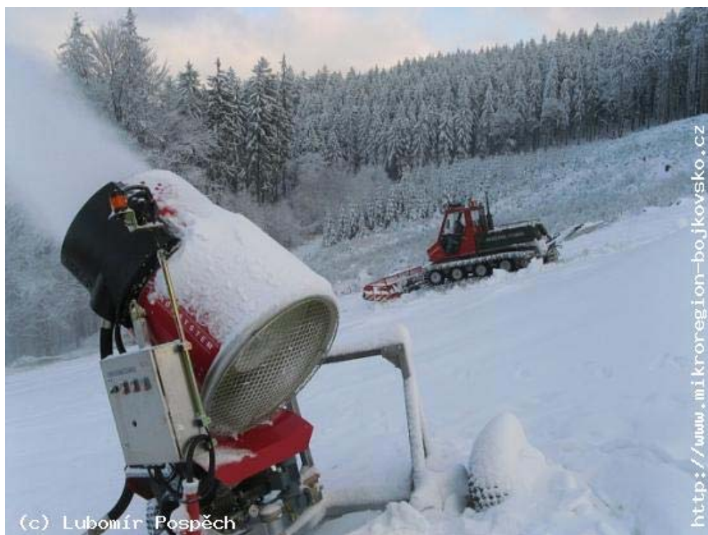
Obr. 6 Zařízení pro zasněžování sjezdových tratí
