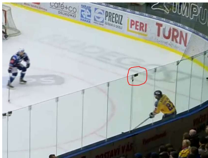
Obrázok 15 - Parketový mikrofón snímajúci hraciu plochu umiestnený na ochrannom plexiskle 55
