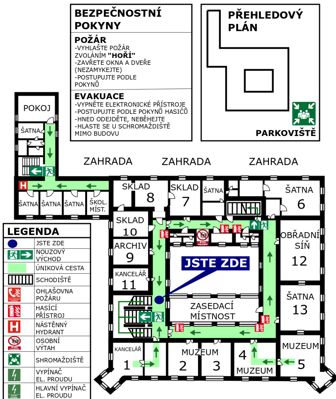
Příloha č. 10: Návrh nového požárního evakuačního plánu-grafická část, 2. NP budova zámku, strana 2/4
