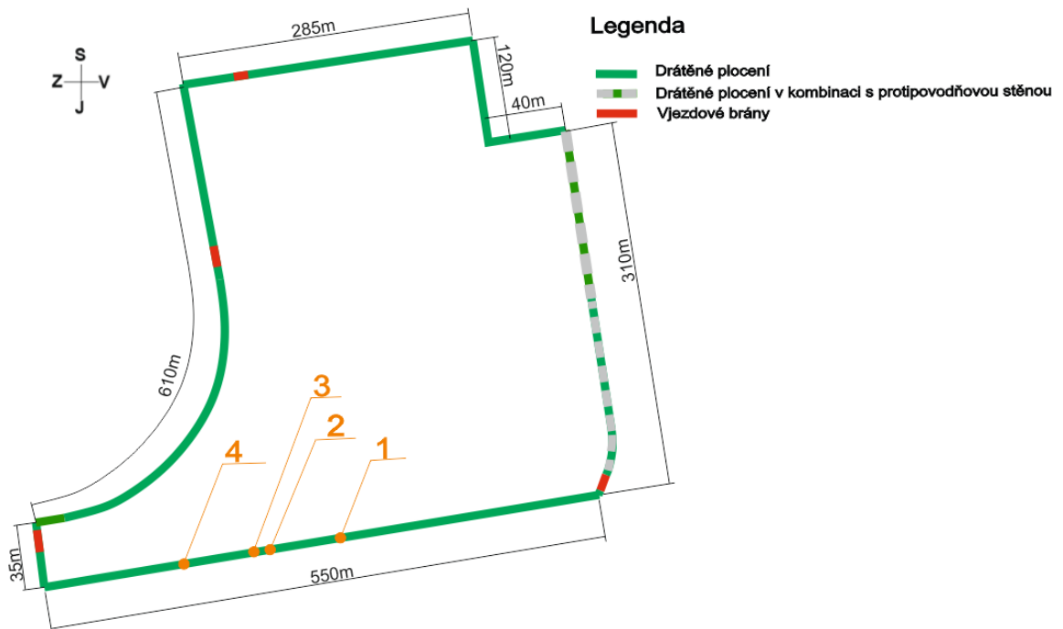
Obr. 22. Situační náčrt poškození oplocení [autor]
