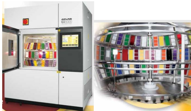
Obr. 12. Exteriér a interiér zkušebního přístroje pro umělé stárnutí a zvětrávání [37]
