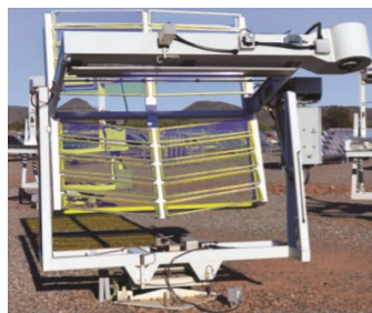
Obr. 13. EMMA: rovníková montáž se zrcátky pro zrychlení stárnutí [38]
