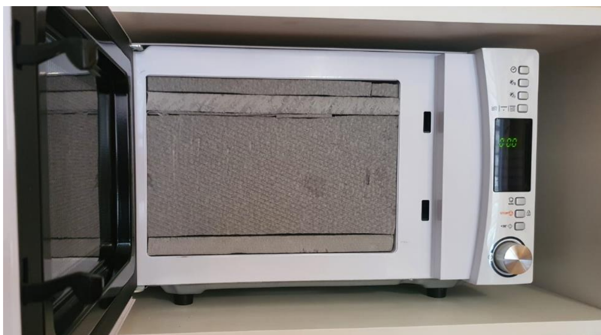
Obr. 7.: Zakryta přední část mikrovlnné trouby za pomoci extrudovaného polystyrenu [Vlastní zdroj]
