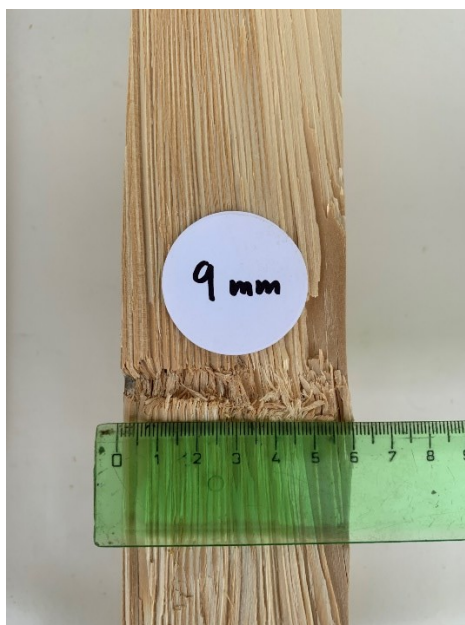
Obr. 26. Měření hloubky průstřelu střely 9 mm Luger [Vlastní].
