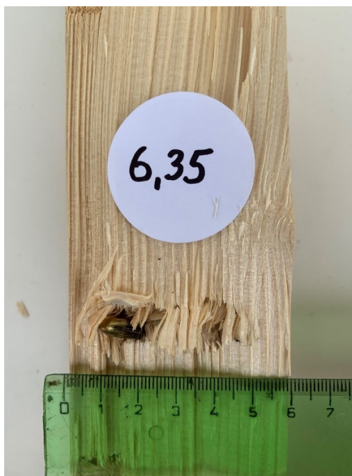
Obr. 22. Měření hloubky zástřelu střely 6,35 mm Browning [Vlastní].
