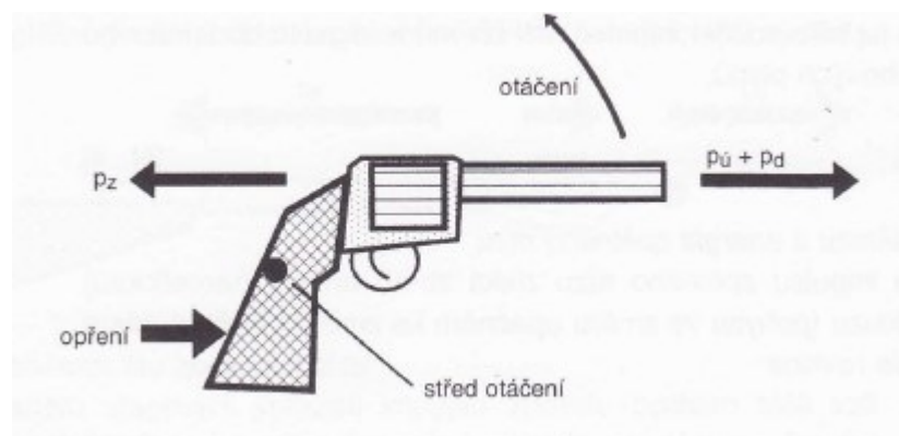
Obr. 3. Točivý moment působící na zbraň [2].
