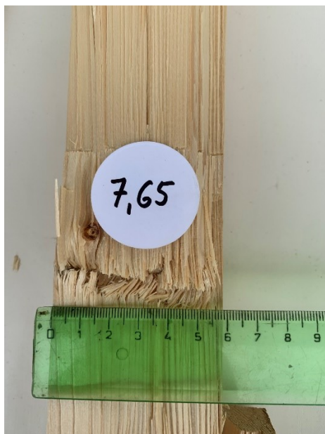
Obr. 24. Měření hloubky průstřelu střely 7,65 mm Browning [Vlastní].
