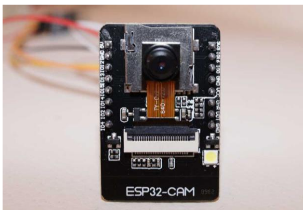
Obrázek 19: Mikropočítač ESP CAM, který obsahuje kameru
