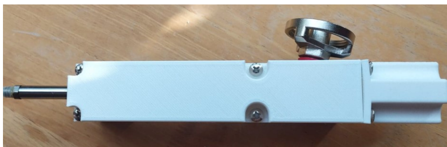
Obrázek 20. Kompletní mechanismus s krytem a aretačním modulem
