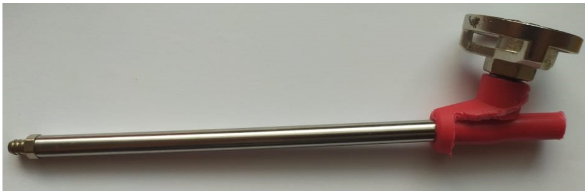
Obrázek 15. Mechanismus ruční aplikační pistole
