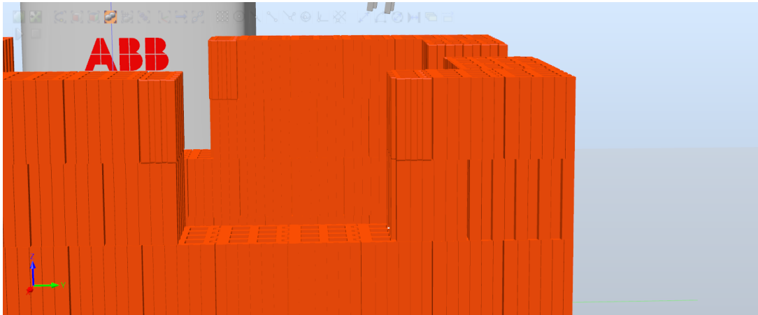
Obrázek 45. Detail mezery pro okno
