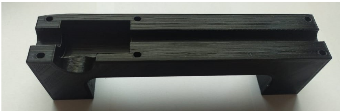
Obrázek 16. Spodní část krytu s dutinou pro mechanismus
