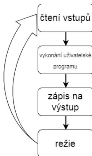
Obrázek 1 - Otočka cyklu pro většinu typů PLC
