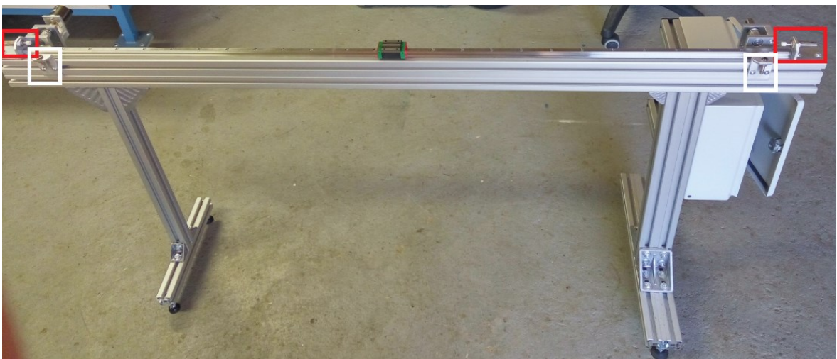
Obrázek 10 – Rám s kolejnici, enkodérem, rozvaděčem, tlumiči a koncovými snímači
