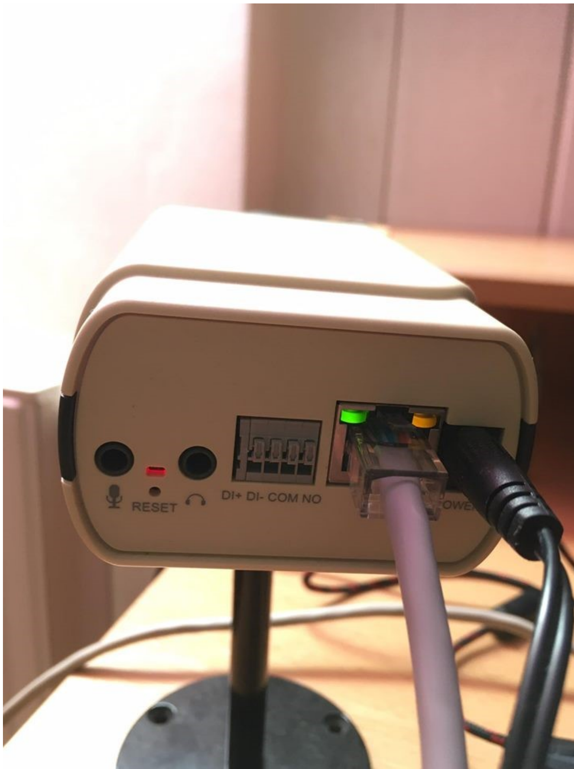
Obrázek č. 7. – Zadní strana kamery – zapojení
