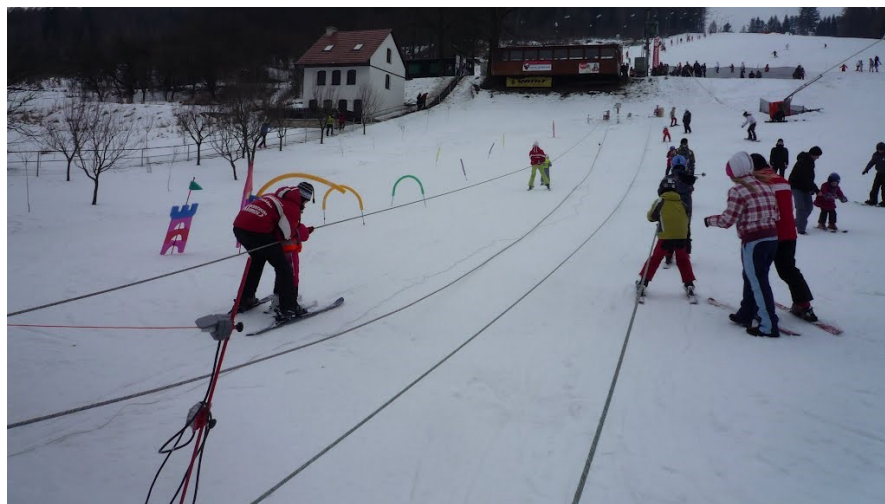
Obrázek 5: Lyžařský vlek s nízkým vedením lana ve ski areálu Filipov [19]
