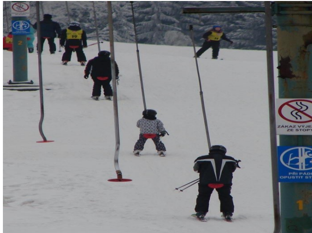
Obrázek 2: Talířový teleskopický lanový vlek [16]
