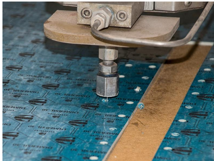
Obr. č. 9 Detail na řezání vodním paprskem
