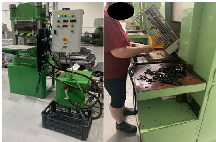
Obrázek 19 - Práce na ručních, etážových vstřikolisech
