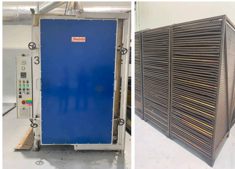
Obrázek 23 - Dovulkanizace výrobků v pecích
