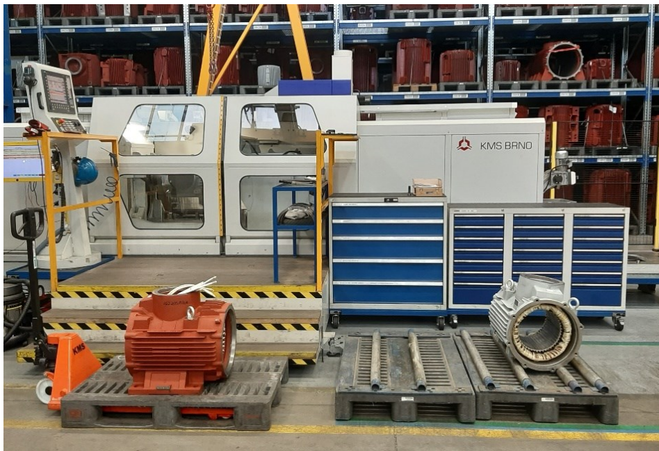
Obrázek 10 – Obráběcí centrum pro přetáčení statorů KMS 1713 (vlastní zpracování)
