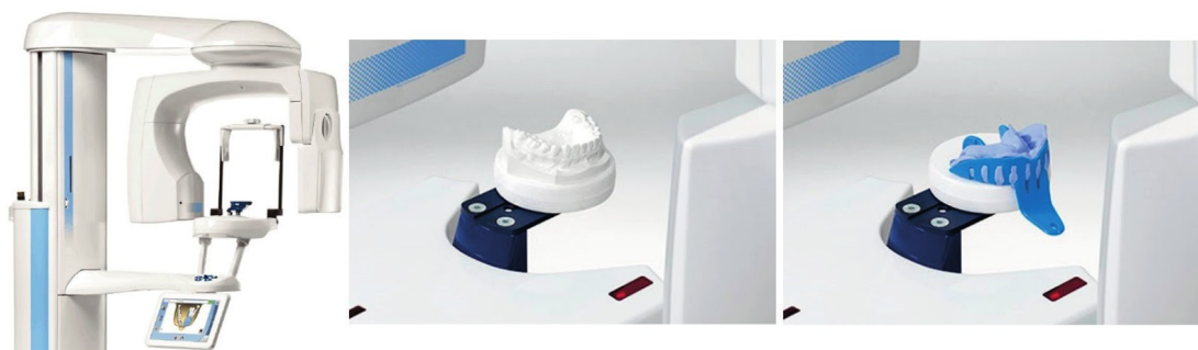
Obr. č. 3: Zubní výpočetní tomograf CT, tvorba digitálního modelu na přístroji Planmeca
