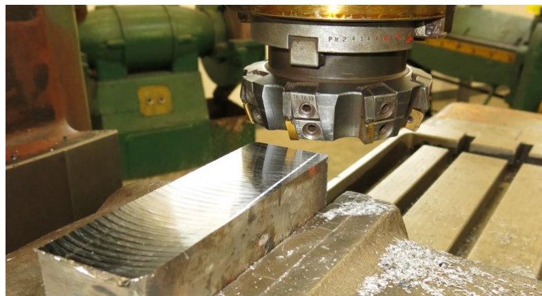
Obr. 7 – Frézování čelem čelní frézy [9]
