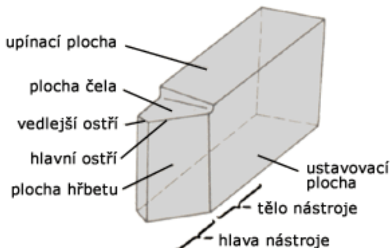
Obr. 2 – Hlavní části soustružnického nože [4]
