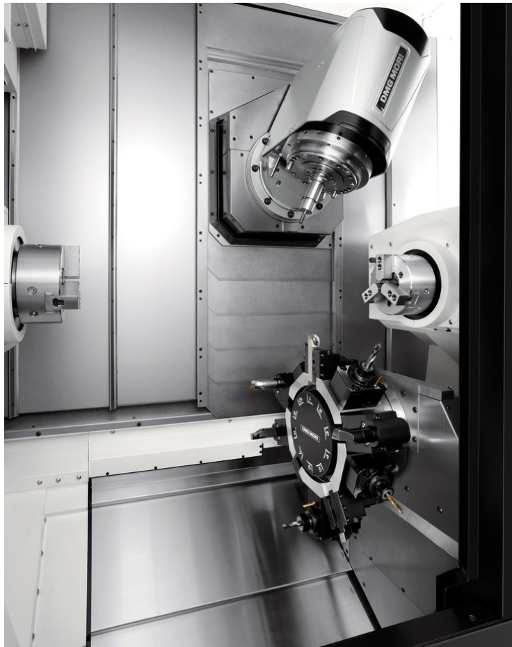
Obr. 17 – Pracovní prostor soustružnicko frézovacího centra DMG Mori NTX 1000 [27]
