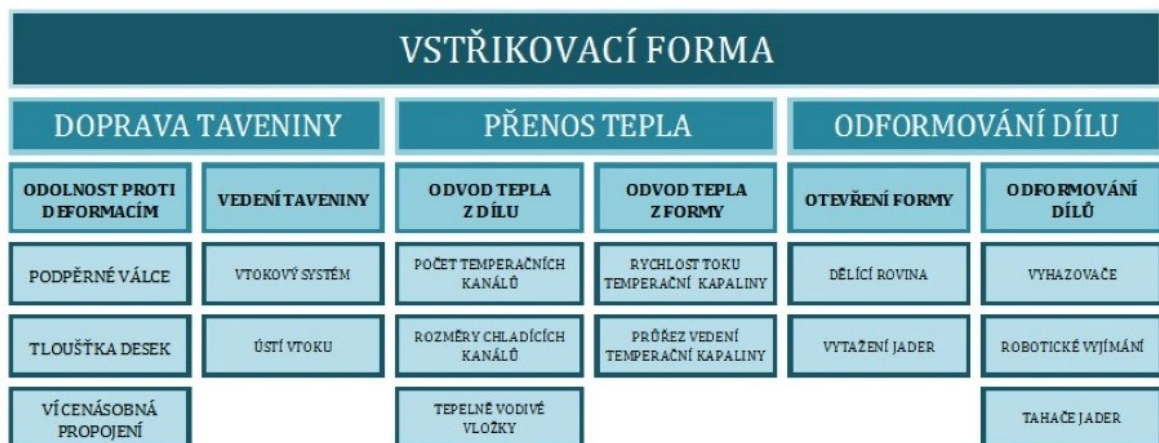
Obrázek 18: Základní funkce a vlastnosti vstřikovací formy [17]
