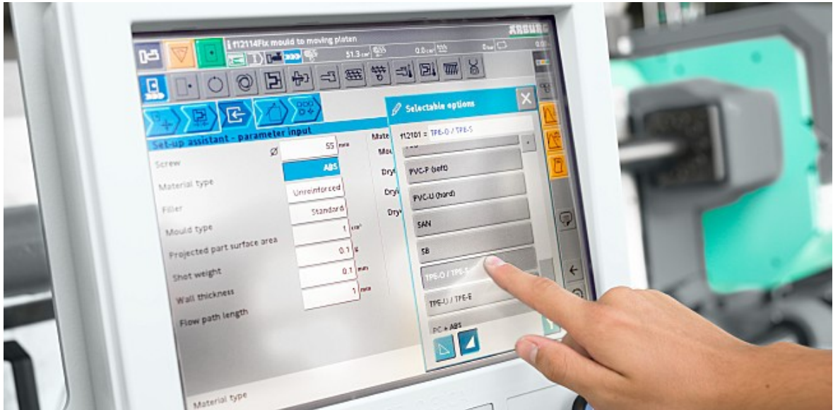
Obrázek 17: Komunikační rozhraní vstřikovacího stroje Selogica společnosti Arburg
