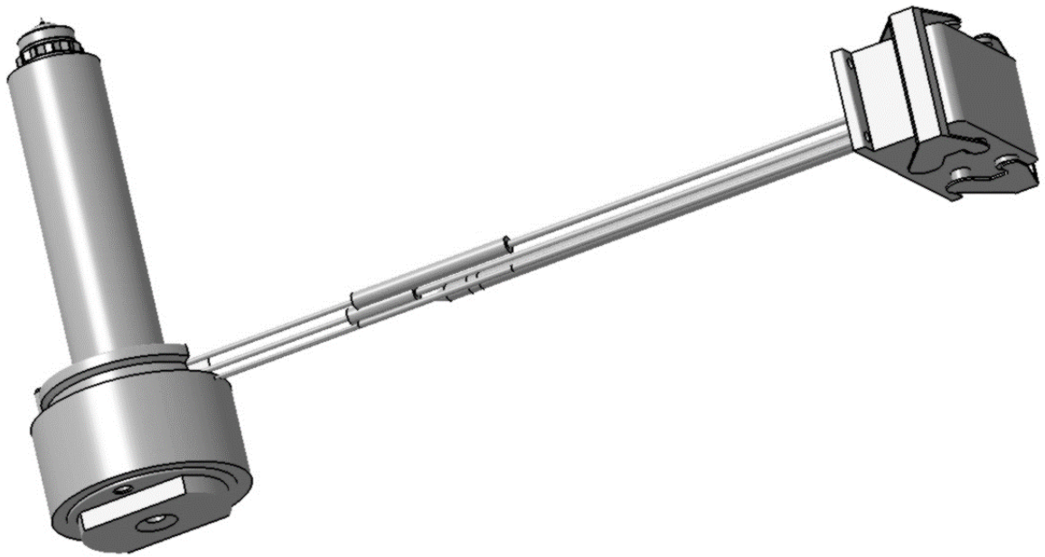
Obrázek 45: Znárodnění vyhříváného vtokového systému
