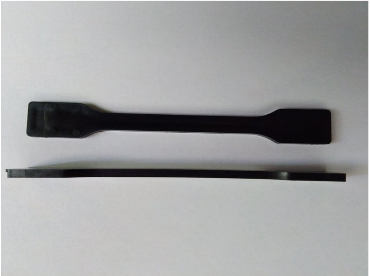
Obr. 22 Odformované zkušební těleso pro další zpracování
