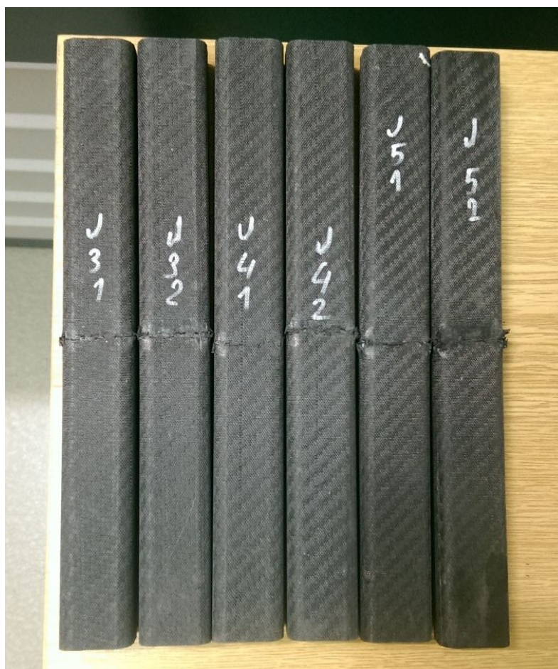
Obrázek 35 Profily s vyšším obsahem skelných vláken a matrice po zkoušce únavy.
