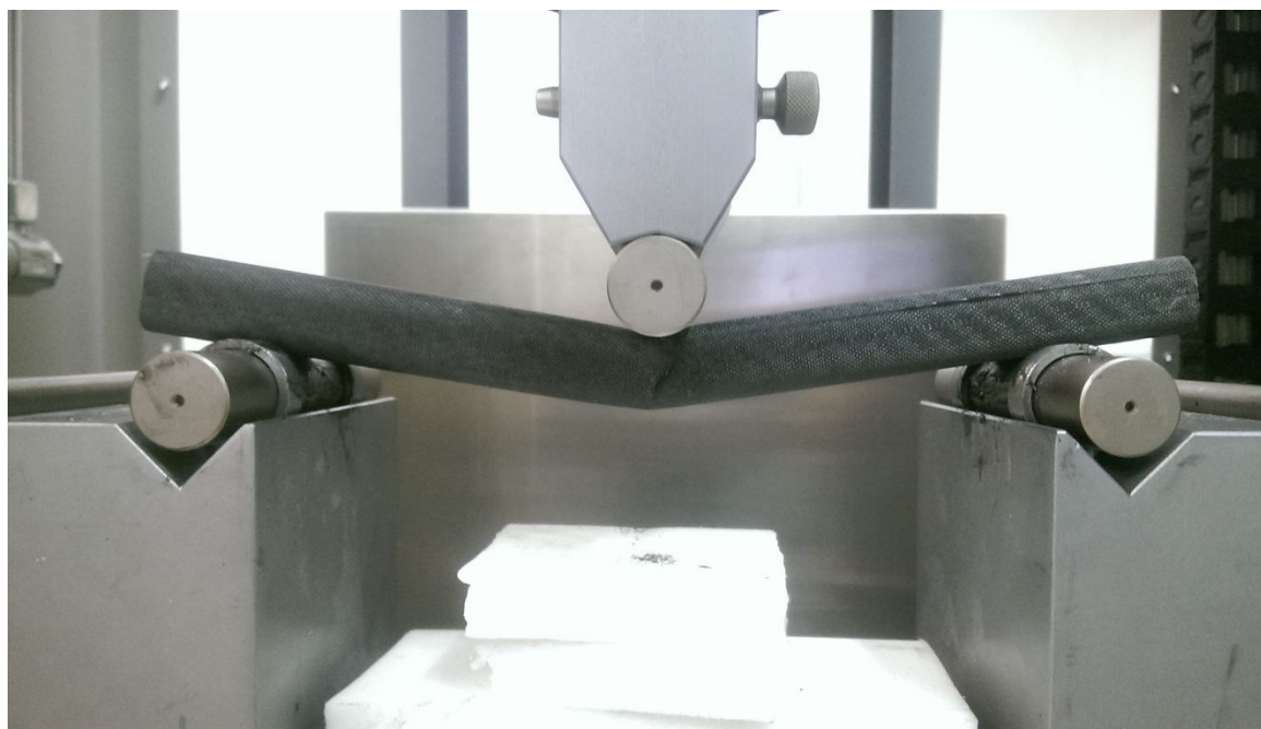
Obrázek 33 Profil s vyšším obsahem skelných vláken při zkoušce.
