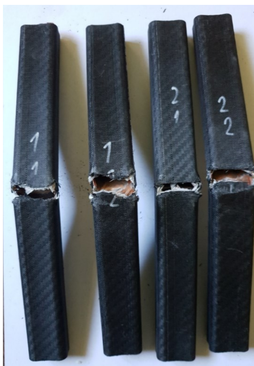
Obrázek 23 Profily s vyšším obsahem skelných vláken po zkoušce v tříbodovém ohybu.
