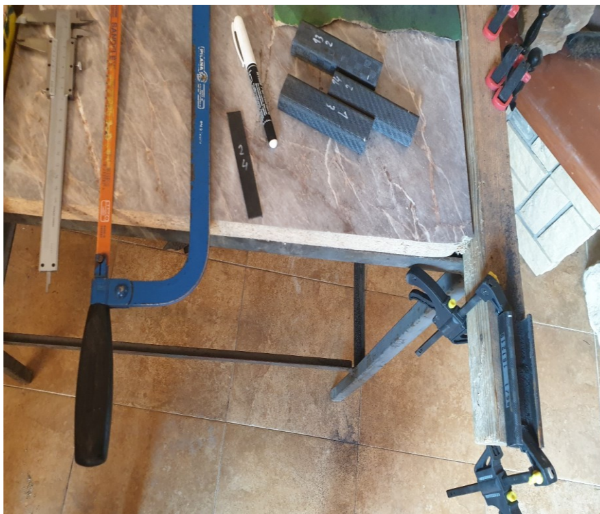
Obrázek 17 Dělení zkušebních těles ruční pilou.
