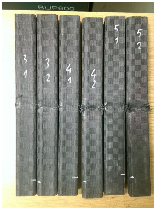
Obrázek 32 Profily s vyšším obsahem uhlíkových vláken po zkoušce únavy.
