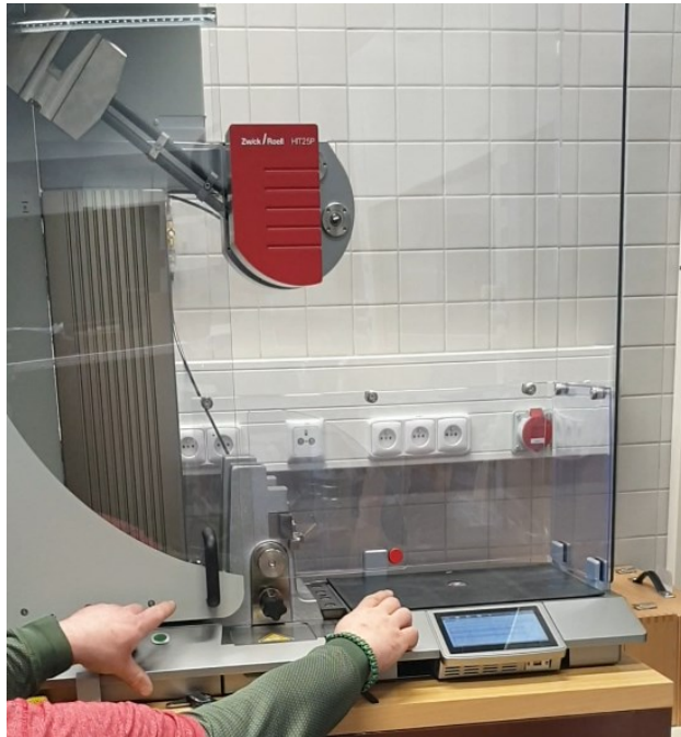
Obrázek 28 Zkušební stroj Zwick/Roell HIT25P po zkoušce.
