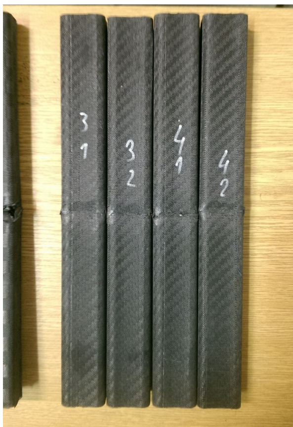
Obrázek 34 Profily s vyšším obsahem skelných vláken po zkoušce únavy.
