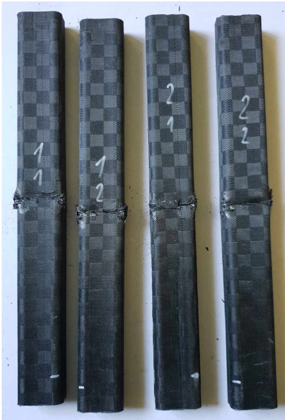
Obrázek 22 : Profily s vyšším obsahem uhlíkových vláken po zkoušce v tříbodovém ohybu.
