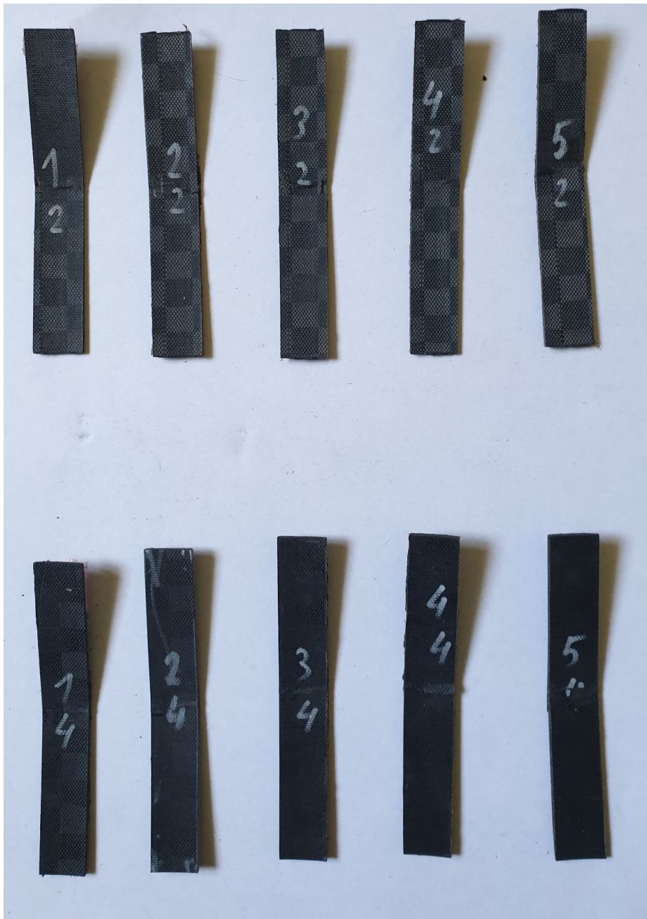
Obrázek 19 Zkušební tělesa s vyšším obsahem uhlíkových vláken po zkoušce v třibodovém ohybu.
