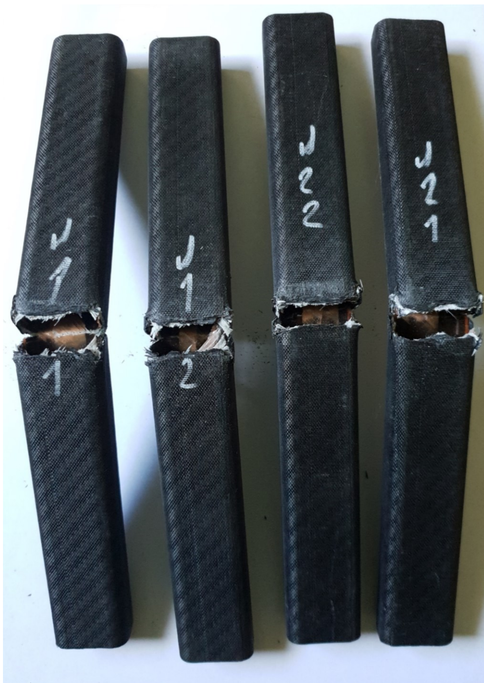
Obrázek 25 Profily s vyšším obsahem skelných vláken a matrice po zkoušce v tříbodovém ohybu.
