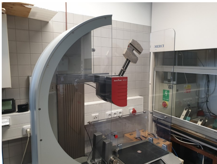
Obrázek 26 Zkušební stroj Zwick/Roell HT 25P před zkouškou.
