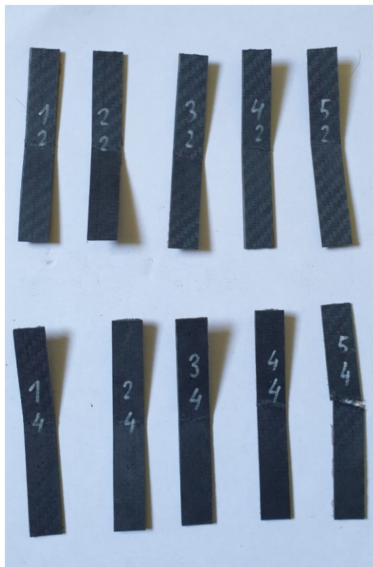
Obrázek 21 Zkušební tělesa s vyšším obsahem skelných vláken po zkoušce v tříbodovém ohybu.
