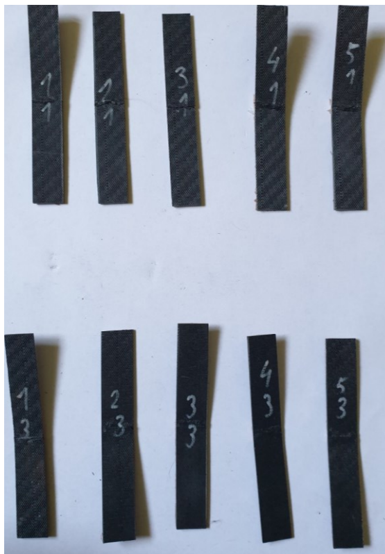
Obrázek 29 Zkušební tělesa s vyšším obsahem skelných vláken po zkoušce rázem v ohybu.
