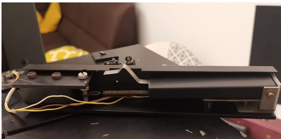
Obrázek 10 Polo rozebraný mechanismus snímače pohybu měřícího kotouče, zdroj: vlastní
