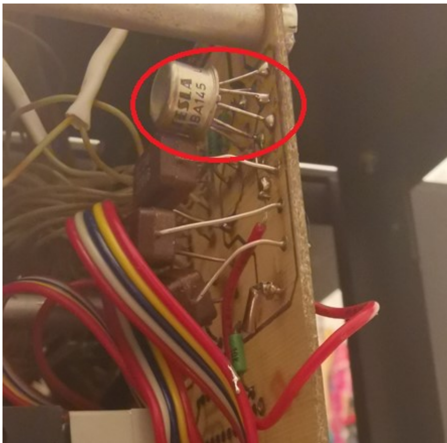
Obrázek 17 Vyměněný diferenční zesilovač MBA145, zdroj: vlastní
