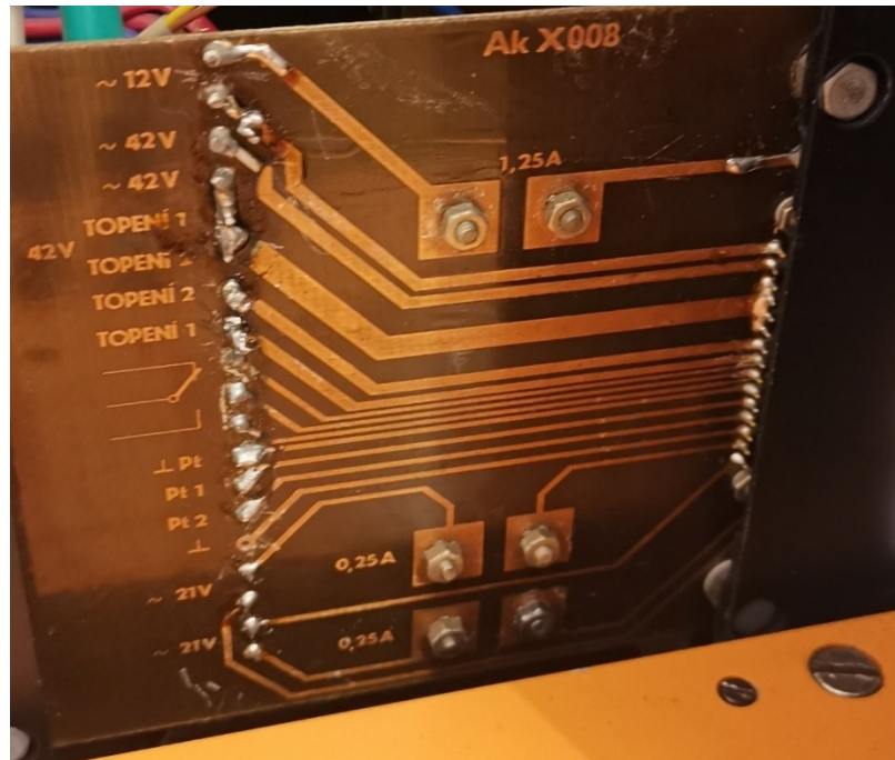
Obrázek 25 Deska AkX008 ze zadní části, vlevo drátové propoje, vpravo 30 pin konektor, zdroj: vlastní
