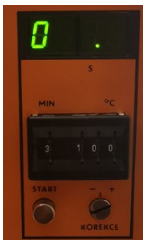
Obrázek 31 Ukončení vytápění na zvolenou teplotu, zdroj: vlastní
