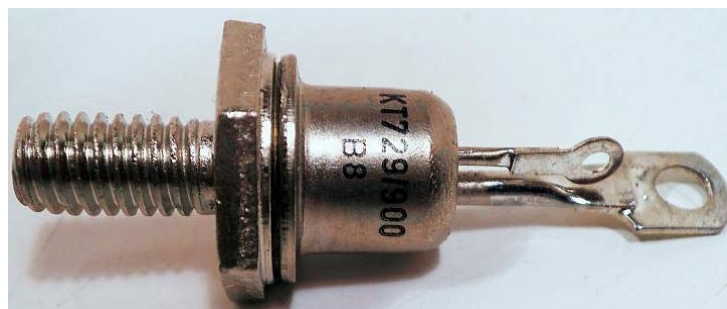
Obrázek 22 Triak bez chladiče, pouzdro K707, závit M6, zdroj: ferity.cz
