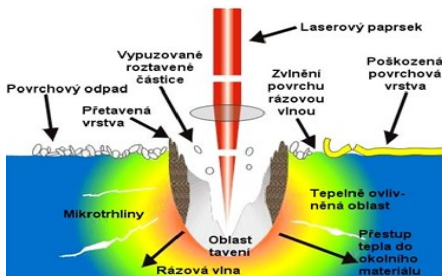
Obr. 9 Schéma principu úběru materiálu laserem [14]
