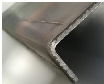
Obr. 50. Vzhled ohybu po ohýbání na ohraňovacím lisu..
