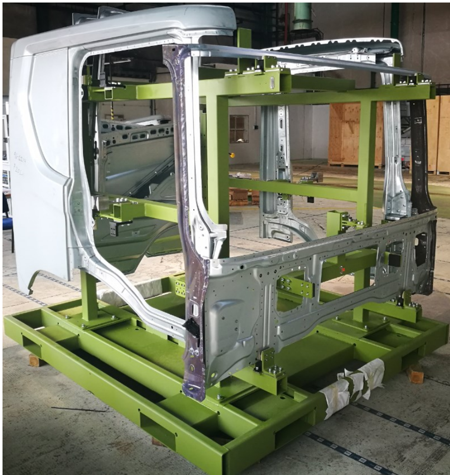
Obr. 38. Fotografie prototypu společného rámu.
