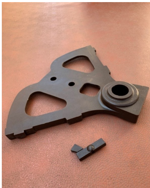
Obr. 37 Porovnání voskových modelů Sperrscheibe a Ključ
