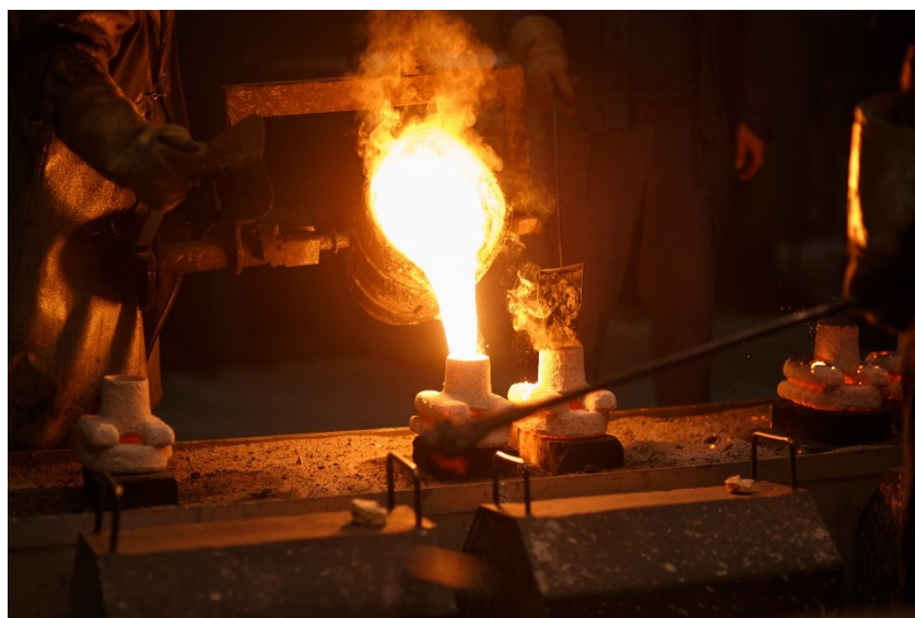
Obr. 28 Gravitační lití do vyžíhaných skořepin
