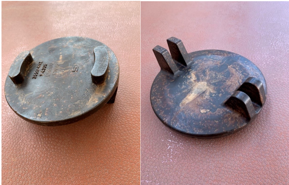
Obr. 30 Voskový model Klapka po vystříknutí
