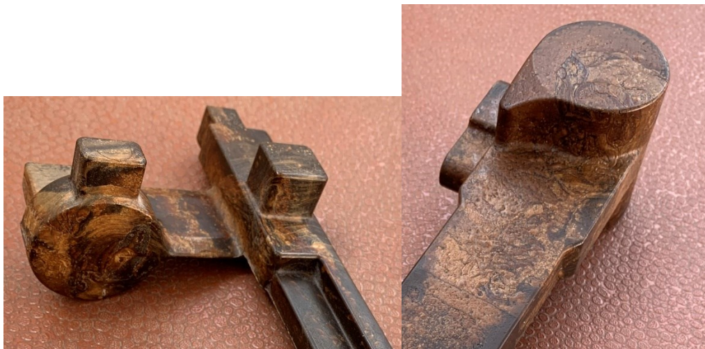
Obr. 31 Voskové modely Carello a Rameno po vystříknutí
