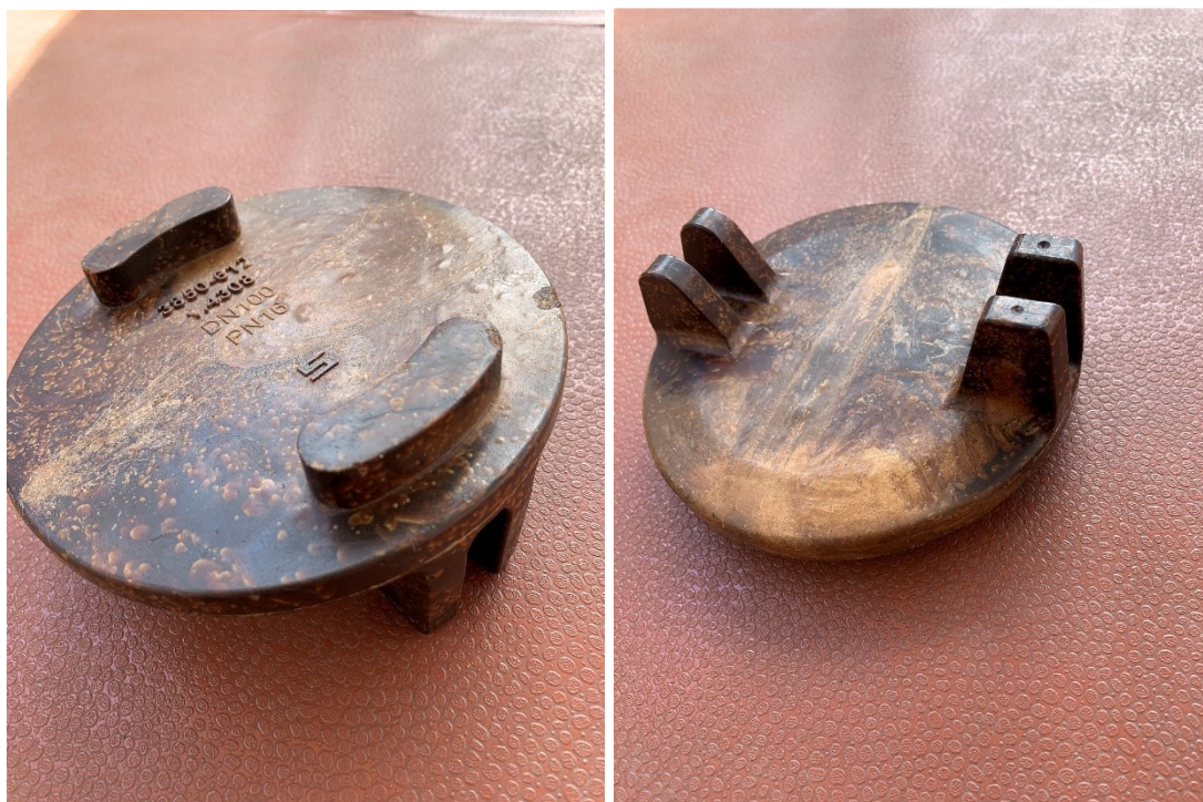
Obr. 34 Nevyhovující voskový model Klapka
