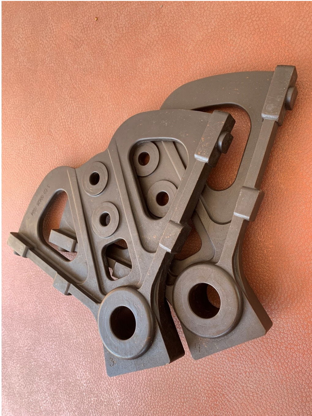
Obr. 45 Voskový model Sperrscheibe 004 před a po úpravě parametrů
