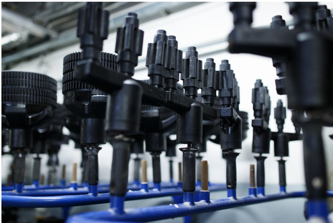
Obr. 6 Voskové modely sestaveny do stromečku
