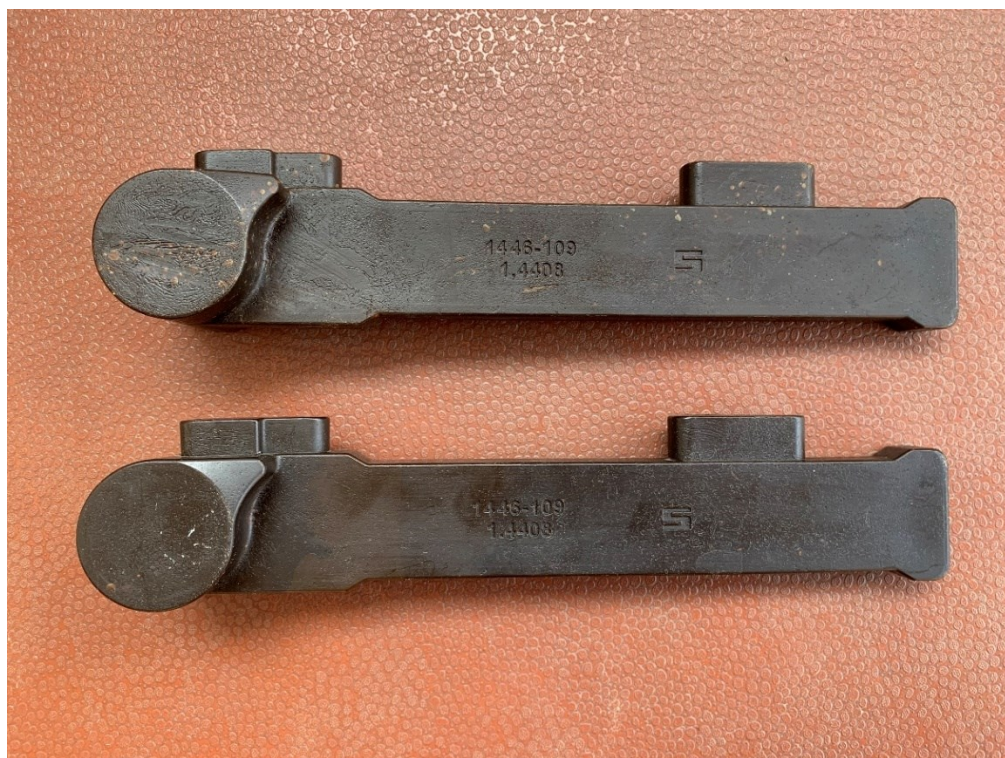
Obr. 40 Voskový model Rameno před (nahore) a po úpravě parametrů
