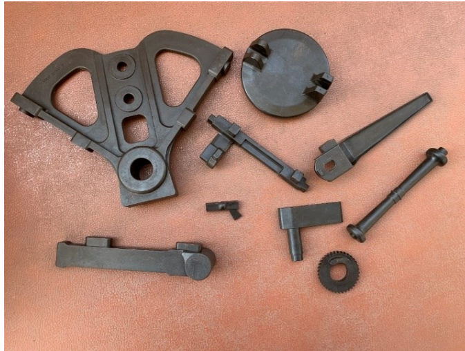
Obr. 36 Vybrané modely pro vstřikování ze směsi PW 3251
