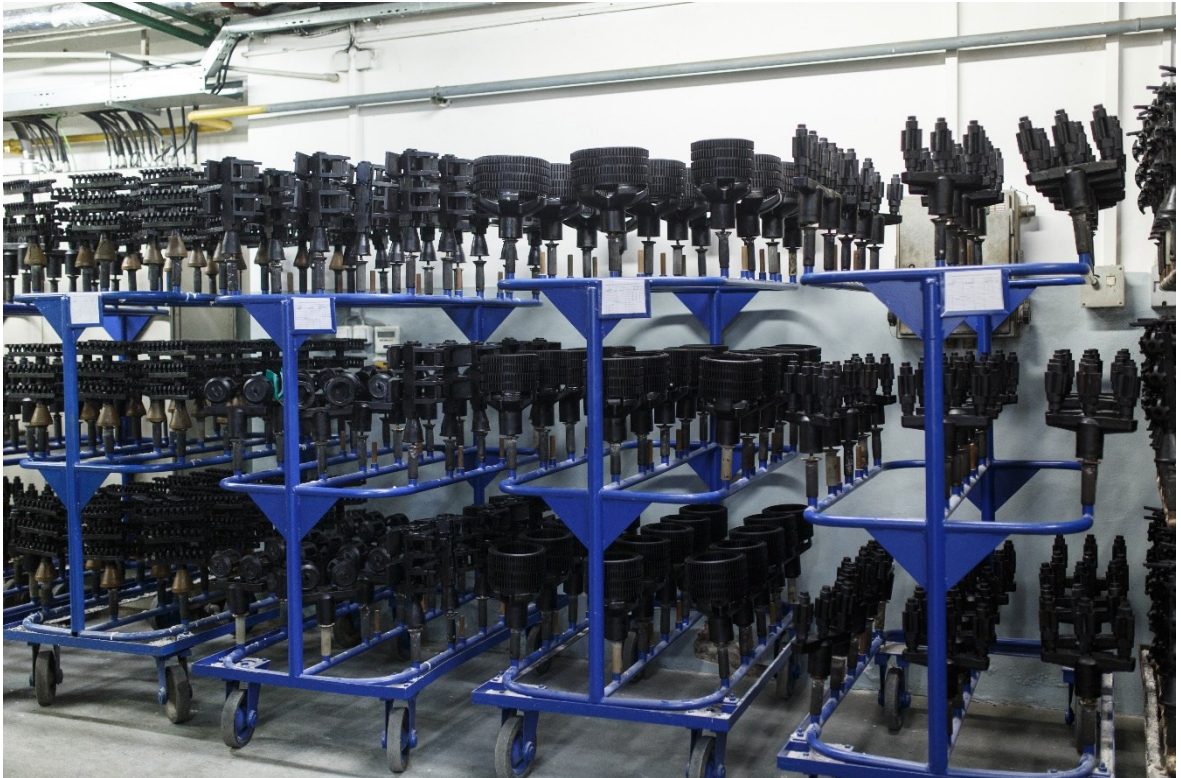
Obr. 25 Voskové modely připojeny na vtokovou soustavu (stromečky)
