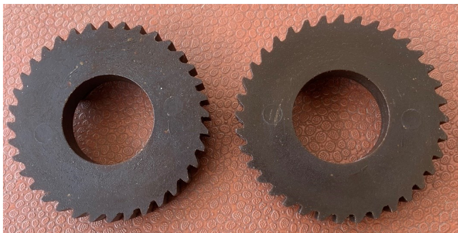
Obr. 41 Voskový model Klinkenrad před a po úpravě parametrů
