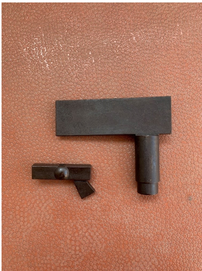
Obr. 38 Voskové modely Ključ a Pant horní levý po prvním vystříknutí
