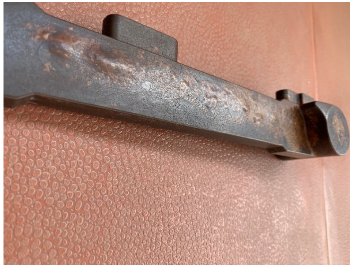
Obr. 32 Bubliny vzniklé na voskovém modelu Rameno
