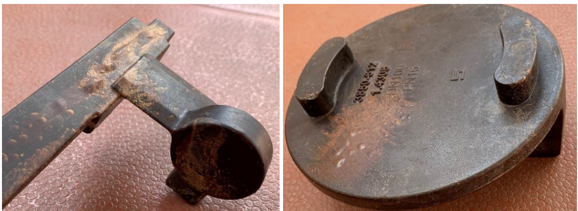
Obr. 33 Vady na voskových modelech Carello a Klapka
