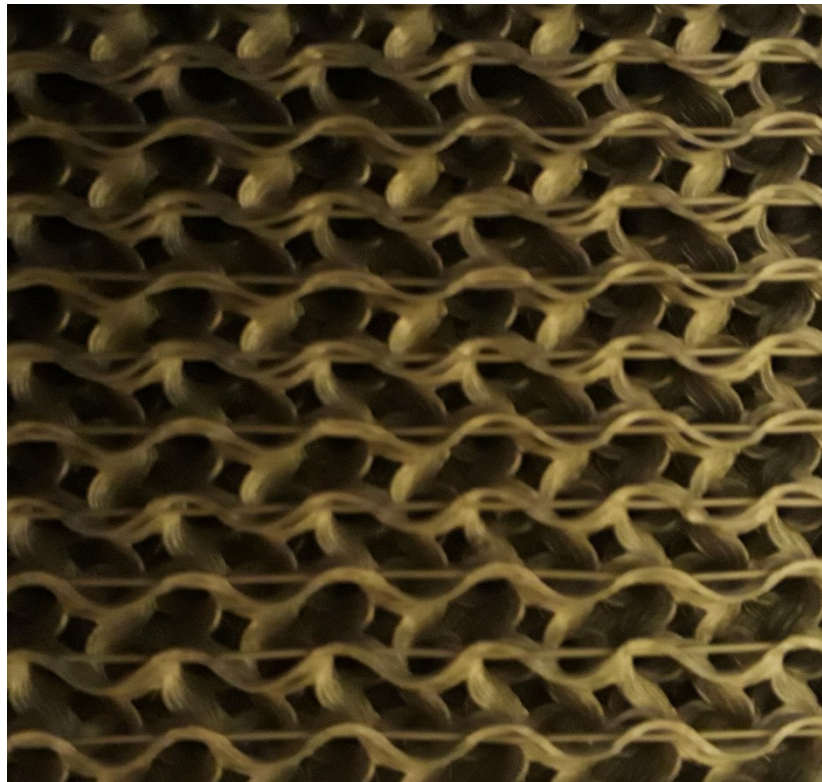
Obrázek 10 Geometricky definovaná porézní struktura typu Gyroid
