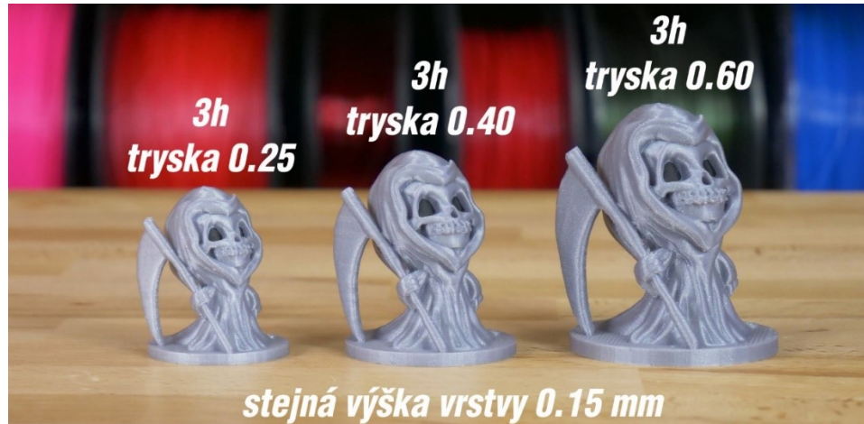
Obrázek 6 Vliv šířky trysky na konečnou velikost výtisku při zachování jednotné výšky vrstvy [17]
