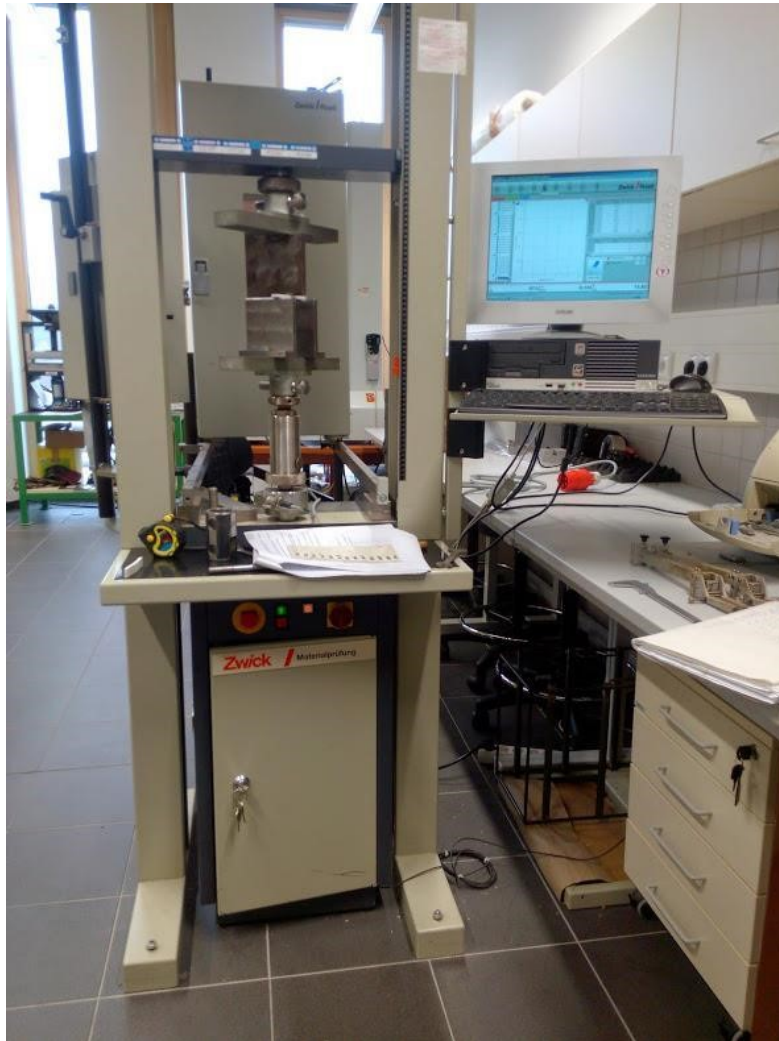
Obrázek 13 Univerzální zkušební stroj Zwick 1456 [12]
