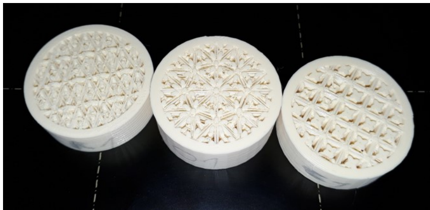
Obrázek 11 Pilotní vzorky tří typů struktur, se kterými se dále se- tkáme v této práci. Technologie výroby FDM, materiál PLA.
