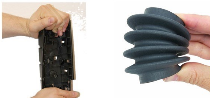
Obr. 18 Chování polymerů při zatížení: plast (vlevo), elastomer (vpravo) [14]
